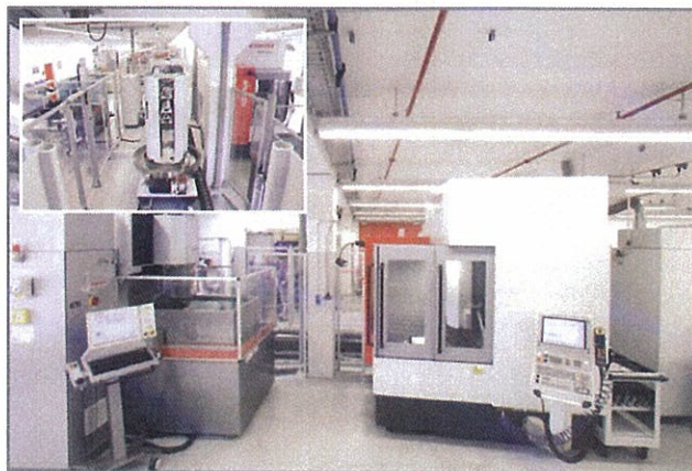
Moderne Technik im Zusammenspiel: Erodieren, Fräsen und Messplatz verkettet über einen Linear-Roboter mit Magazinen. Foto: Gemü
